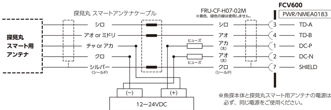
※魚探本体と探見丸スマート用アンテナの電源は、必ず、同じ電源をご使用ください。
